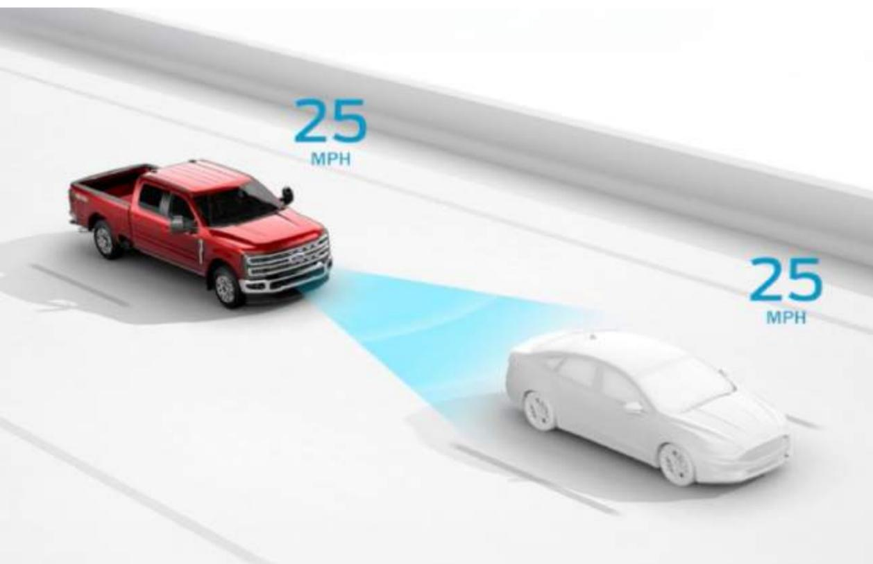
**Asistencia de pre-colisión con freno de emergencia automático**
